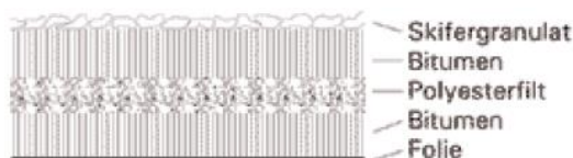
Figur 1 Opbygning af PTM BituFlex
